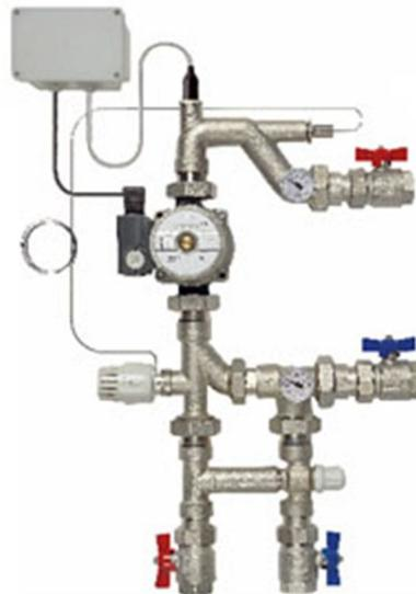
Смешение воды происходит при помощи трехходового клапана, сигнал на который подается от датчика подающей воды "теплого пола". Датчик безопасности обеспечивает безопасную работу системы и производит автоматическое отключение смесительного узла при превышении температуры подающей воды в контуре теплого пола более 45-55°C.
