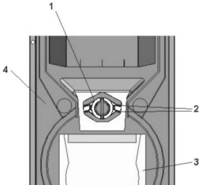
Установка колосниковых сегментов изображена на рисунке и одинакова как для сжигания угля, так и древесины. Каналы привода вторичного воздуха должны быть всегда направлены вниз.
