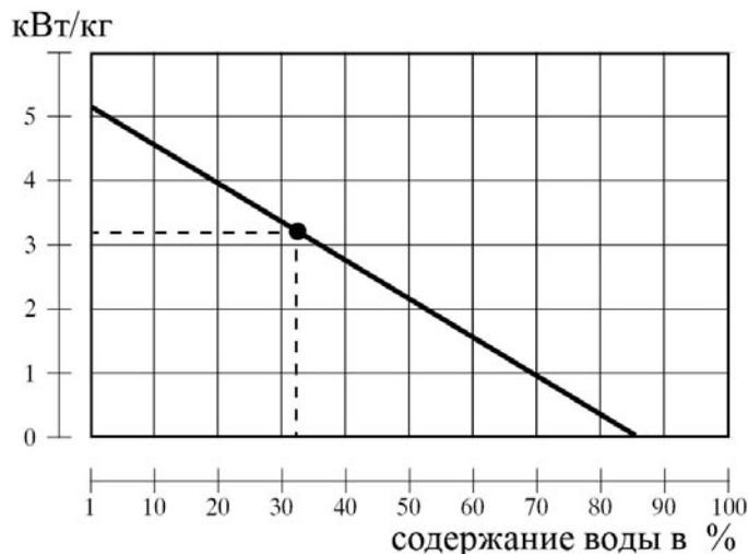
Максимальная мощность котлов при сжигании мокрого топлива представлена на графике.
