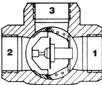
Терморегулирующий вентиль «ESBE» типа «TV 60°C» используется в котлах, работающих на твёрдом топливе. При температуре воды в котле + 60°C откроется терморегулирующий вентиль, и в котловой контур (3→1) поступит жидкость из контура отапливаемого объекта (2). Приводы 1 и 3 постоянно открыты. Таким образом обеспечена минимальная температура возвратной воды в котле. В случае необходимости можно использовать терморегулирующий вентиль, наставленный на более высокую температуру (например, 72°C).
