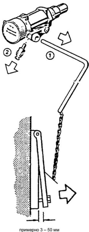
Демонтировать рычаг /1/, соединитель /2/ и регулятор привинтить к котлу.
