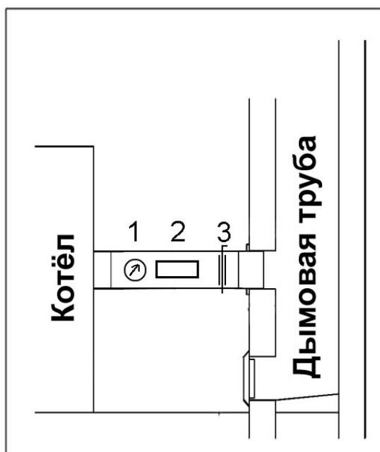
1. Термометр топочных газов
