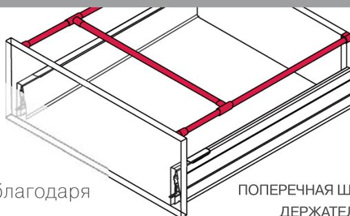
ПОПЕРЕЧНАЯ ШТАНГА / ДЕРЖАТЕЛЬ ДЛЯ ПОПЕРЕЧНОЙ ШТАНГИ
