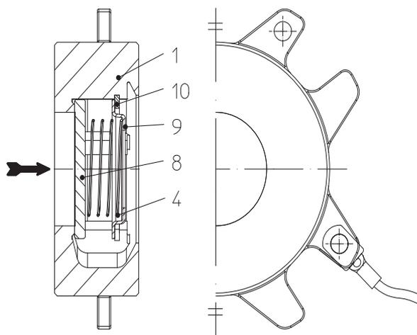
Рис. 7: СНЕСКО®-D PN40 - Дисковый обратный клапан
