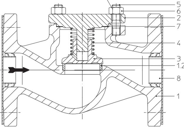
Рис. 1: CHECKO<sup>®</sup>-V - DG PN16-40
