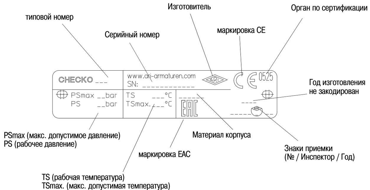
Рис. 8: Типовая табличка (шилдь)
