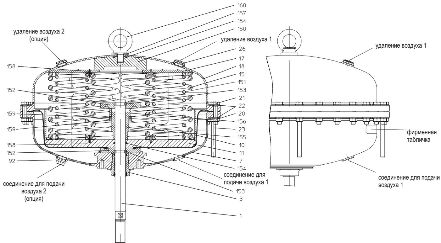
Принцип действия: шток привода втягивается за счет силы пружины
