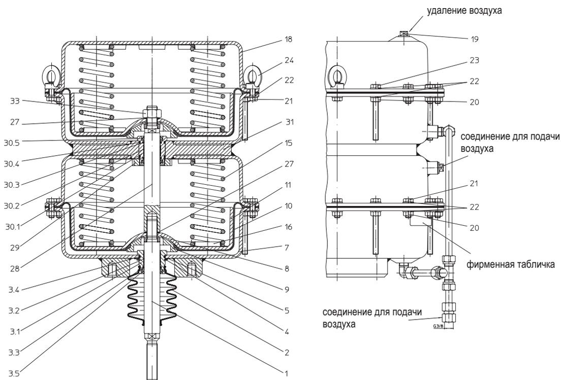
Принцип действия: шток привода втягивается за счет силы пружины
