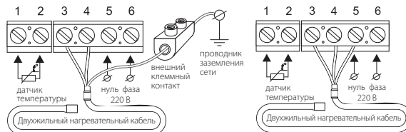
Схема подключения к 3-х проводной электрической сети
