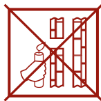
недостаточная тяга (Не используйте котел!)
