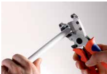
Отрезание трубы при помощи труборезных ножниц
