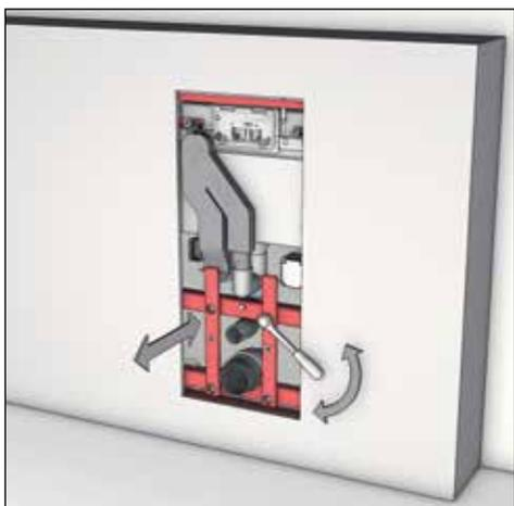
Регулировка глубины монтажных опор для стеклянной панели.
