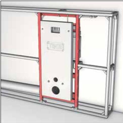
Установка шаблона для отделки отверстия в стене.
