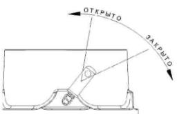
Модели со встроенной шиберной заслонкой имеют возможность контролировать выход дымовых газов (открыто - закрыто).
