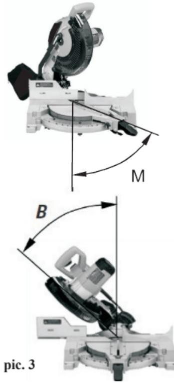
Две заготовки с различными углами должны с предельной точностью состыковываться друг с другом (рис. 6). Нажмите кнопку HOLD/SUP (11) и удерживайте ее более 1 сек, чтобы получить дополнительный угол. Это и будет угол наклона.
