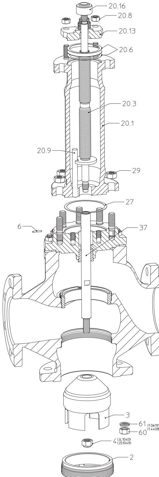
Рис. 17: BR 451 DN125v-150v со смесительным затвором
