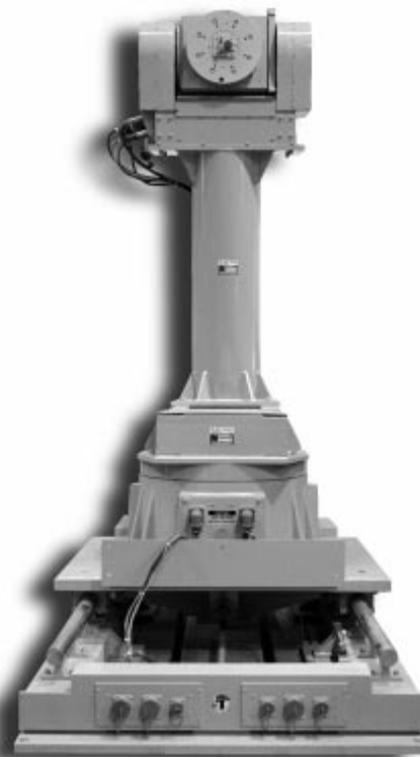
Типовое устройство позиционирования коллиматорных комплексов
