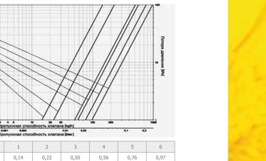
■ гидравлические характеристики клапана Schlosser при различных режимах настройки
