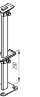
■ рисунок 4 - Стойка для напольного крепления
