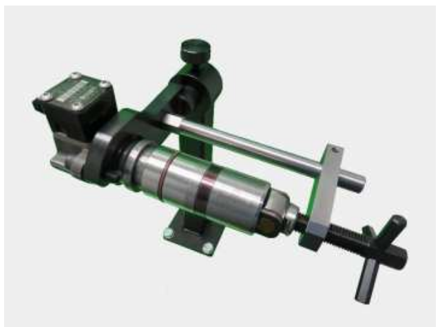
Установка в трубине насосной секции MB ACTROS
