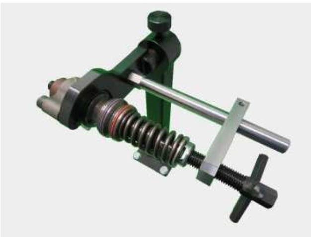
Установка в трубине насосной секции Delphi 082240354
