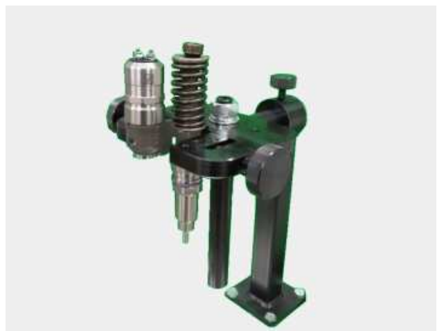
Установка в струбцине насос-форсунки SCANIA Ч-образной
