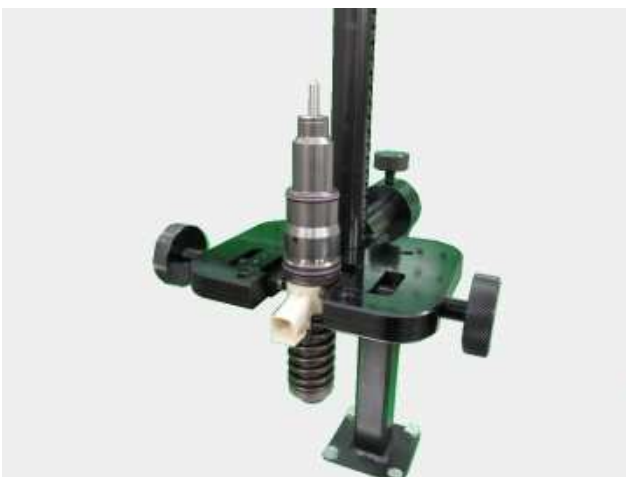
Установка в струбцине насос-форсунки VOLVO Delphi 2x и 4x контактные
