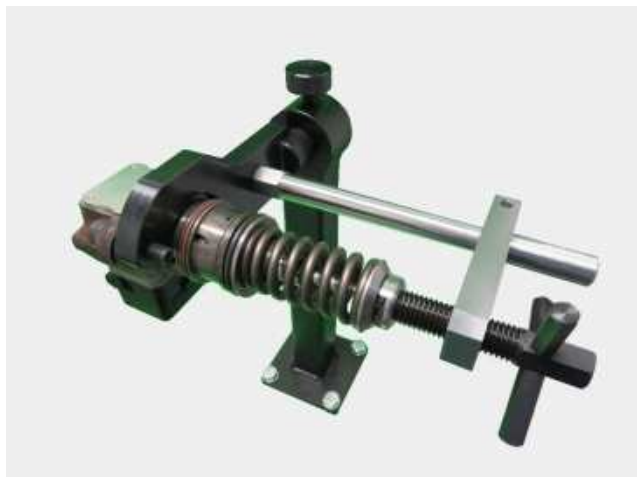
Установка в трубине насосной секции DAF Bosch 0414755005
