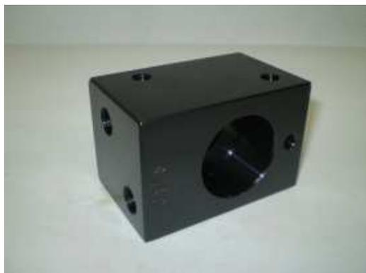
**Зажим для форсунок Volvo FH12 и некоторых форсунок Iveco фирмы Bosch**
