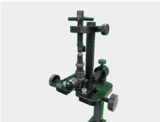
Установка в струбцине насос-форсунки AUDI/VW 1.9
