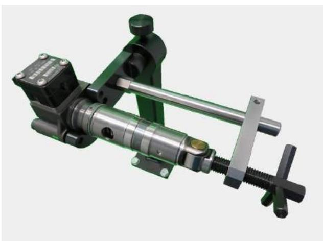
Установка в струбцине насосной секции
