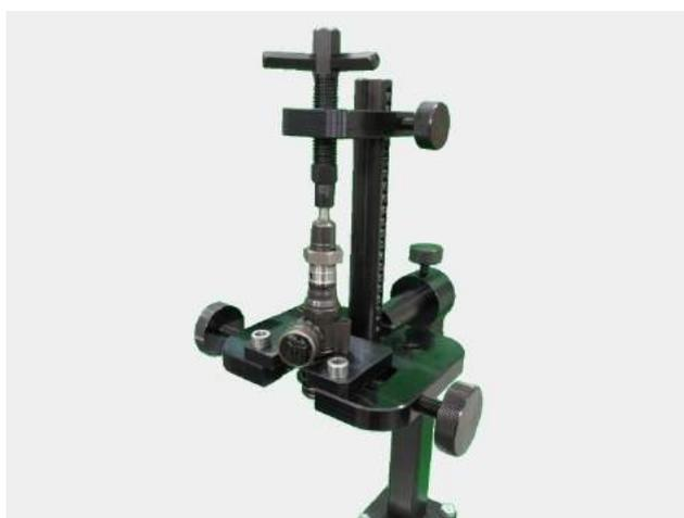
**Установка в струбцине насос-форсунки
