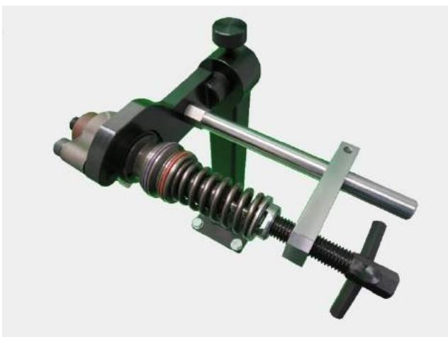
Установка в струбцине насосной секции
