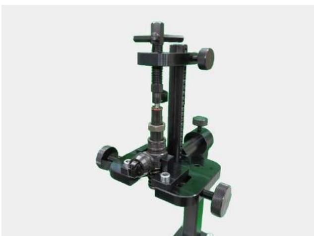
**Установка в струбцине насос-форсунки
