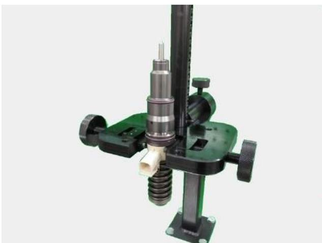
**Установка в струбцине насос-форсунки
