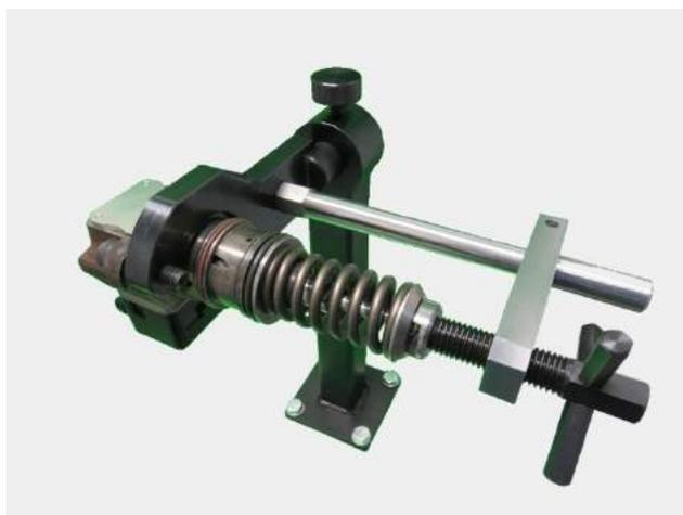
Установка в струбцине насосной секции
