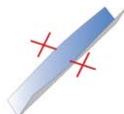
Without crowning of bed Sans système de compensation de la flexion du banc
