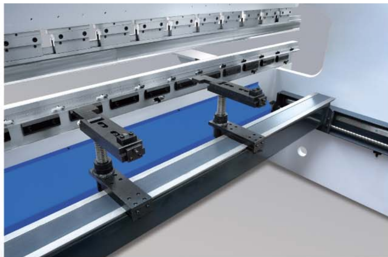
X The back gauge configuration available is as per PBB series (p. 5-6) Les configurations de butée arrière disponibles sont les mêmes que pour la série PBB (p. 5-6)
