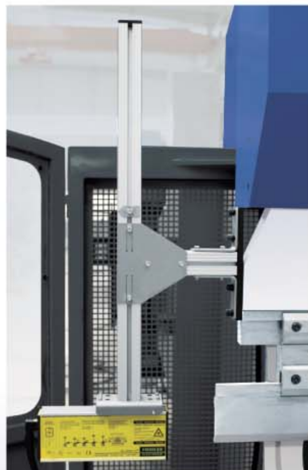
Laser safety device (standard) Système de sécurité laser (standard)
