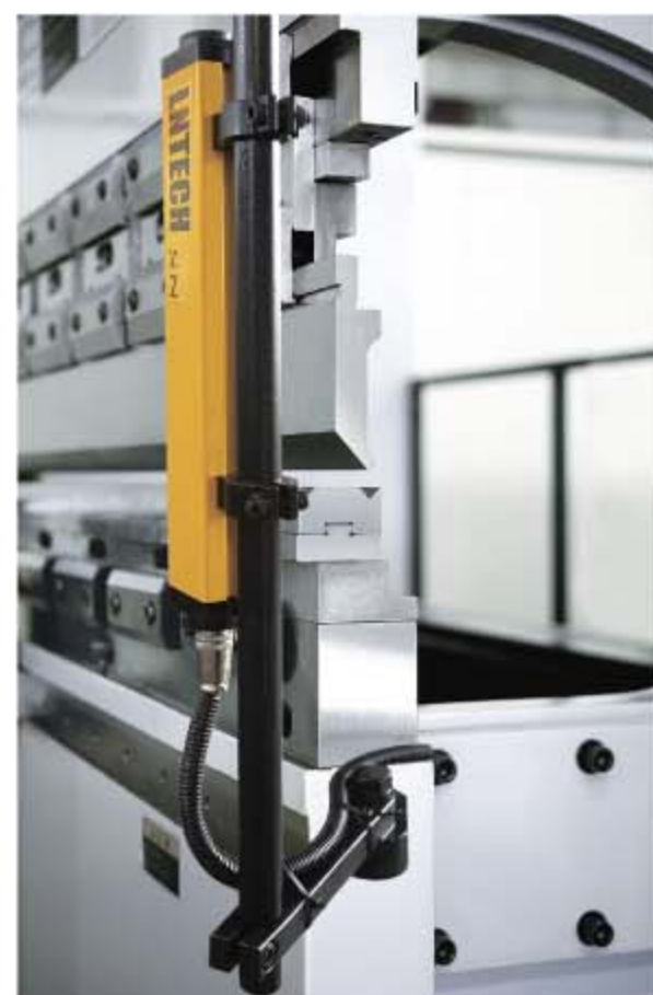
Light curtain safety device (option) Système de sécurité par rideaux lumineux (optionnel)
