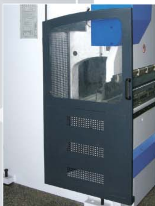
Lateral door-type guarding (standard) Gardes latéraux de type portes (standard)
