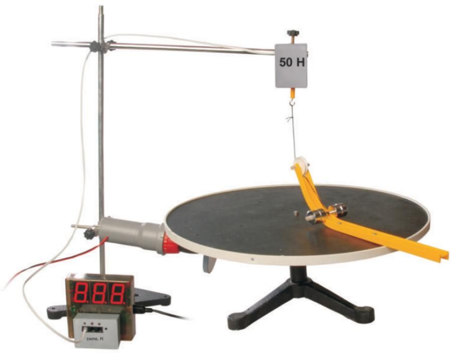
Цифровая лаборатория «Вращение» предназначена для проведения демонстраций при изучении движения тел по окружности и вращательного движения твердого тела на уроках физики и естествознания в средней школе. Используя цифровую лабораторию, можно провести не менее 21 демонстрации.
