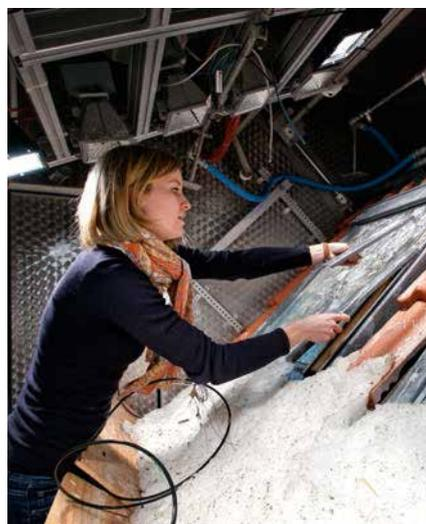
Испытания на стойкость к воздействию снега и льда проходят в два этапа: сначала в лаборатории, а потом в реальных тестовых домах.
