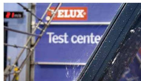
Надежная воздухо- и водонепроницаемость подтверждается проверкой в аэродинамической трубе.
