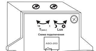
Рис.3 Фрагмент панели управления с регуляторами времени включения и чувствительности.
