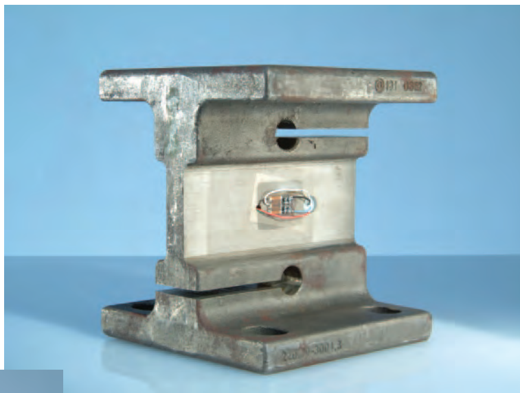
Установка тензорезистора на объект измерения
