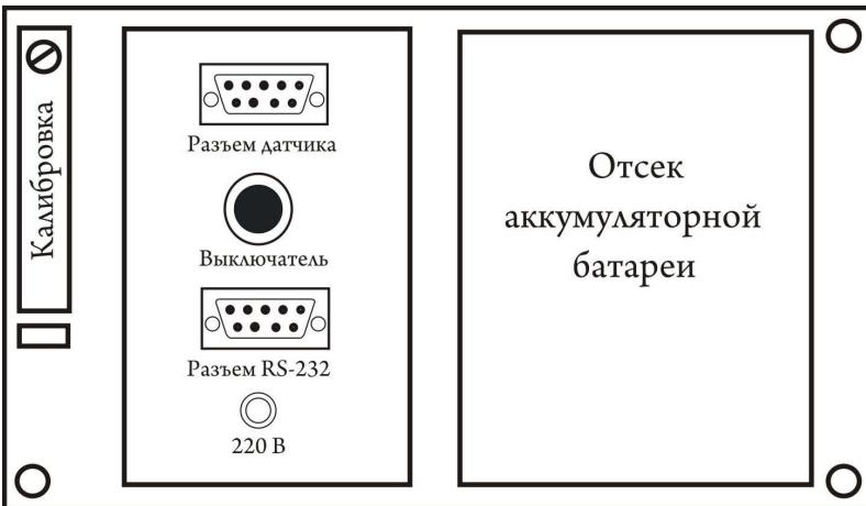
Рисунок 2 - Задняя панель прибора
