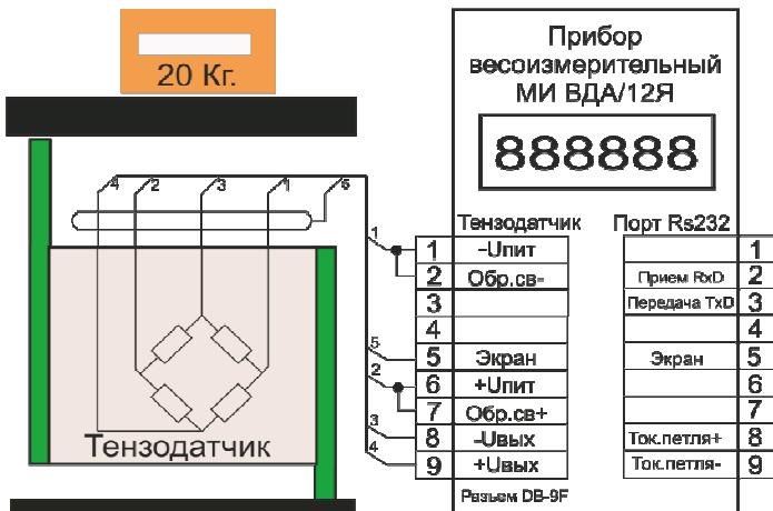
Рис. 4 4-х проводная схема подключения.
