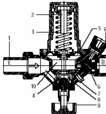
1. Подключение для шланга. 2. Установочный винт.
