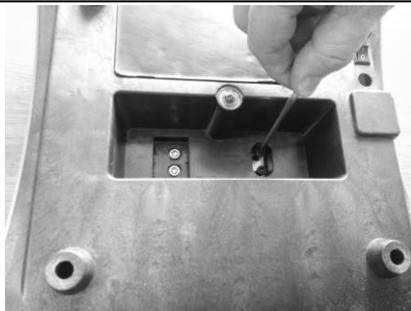
Прикрутить двумя болтами датчик к грузовой платформе Г-образным шестигранным ключом.
