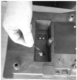
Взять два болта с внутренним шестигранником и установить в отверстия для прикручивания платформы к датчику
