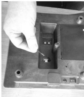
Взять два болта с внутренним шестигранником и установить в отверстия для прикручивания платформы к датчику
