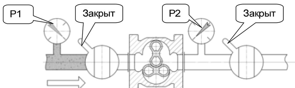
Рисунок 9- Положение запорных устройств до начала пуска
