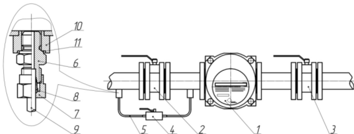
Рисунок 8 - Установка счетчика с перепускным каналом
