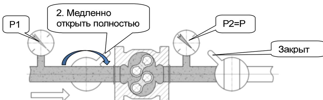
Рисунок 11 – Полное открытие запорного устройства до счетчика
