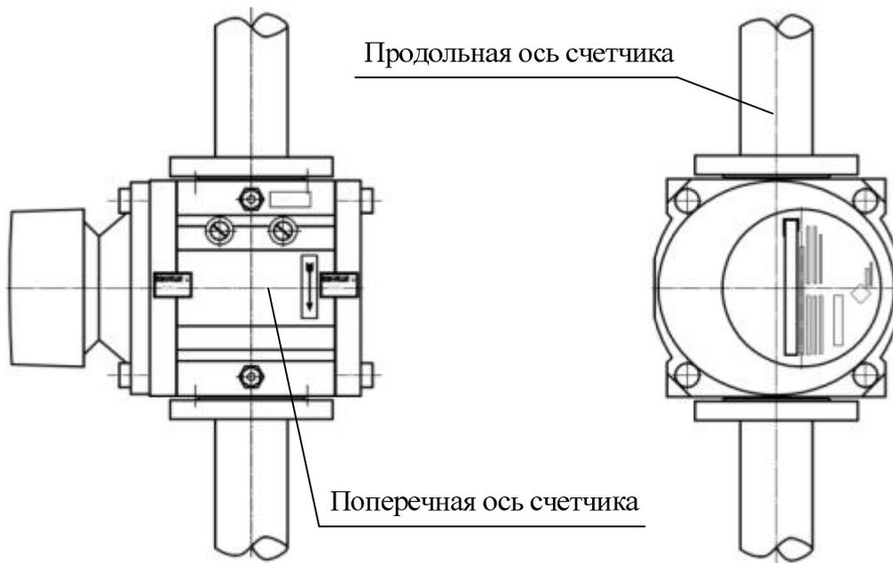
При вертикальном расположении счетчика допустимое отклонение поперечной оси от горизонтальной плоскости не более  $\pm 1^\circ$  и продольной оси не более  $\pm 4^\circ$  от вертикали.
