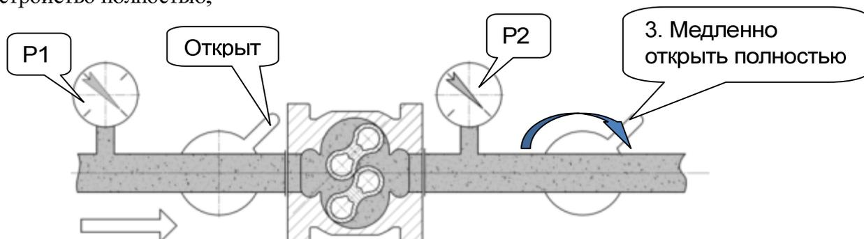
Рисунок 12 – Окончательный запуск
