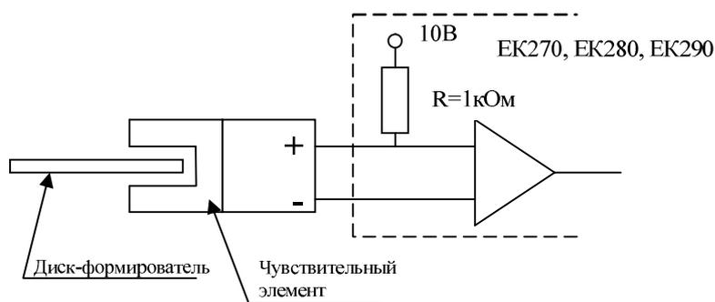
Рисунок 19 – Схема среднечастотного датчика импульсов R300
