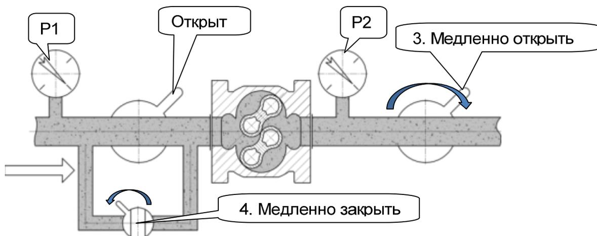
Рисунок 15 – Окончательный запуск
