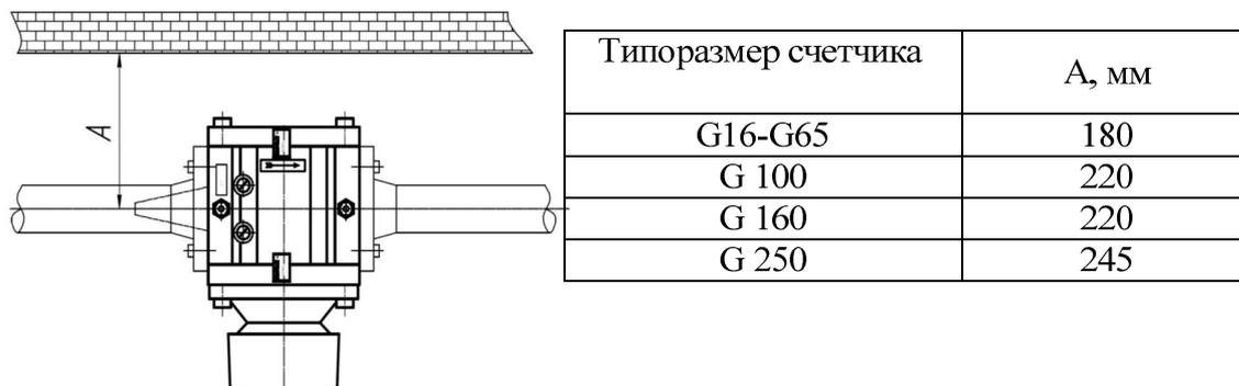
Рисунок 2 – Минимальное расстояние счетчика до стены
