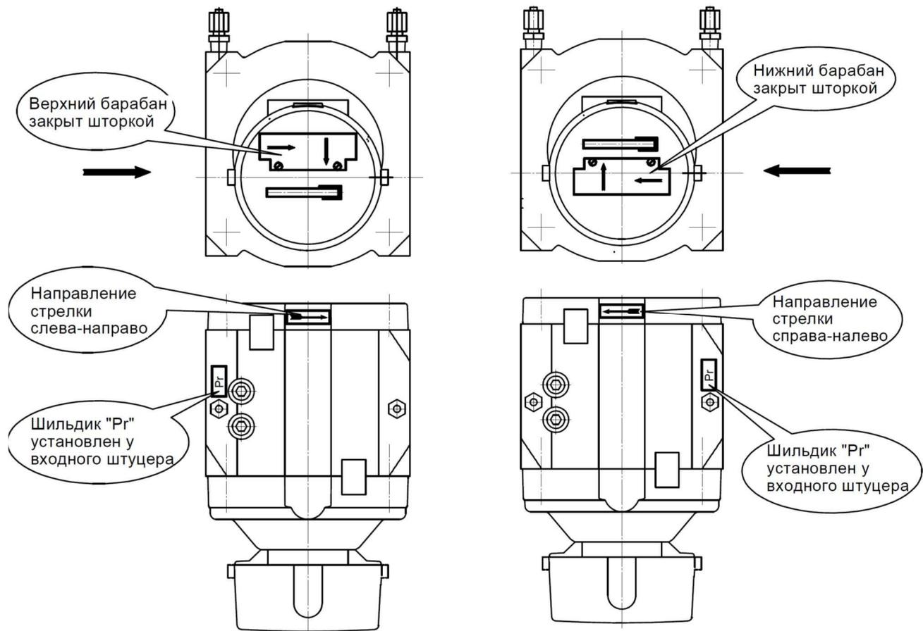
Рисунок 3 – Установка шторки и шильдиков при направлении потока газа слева-направо.
