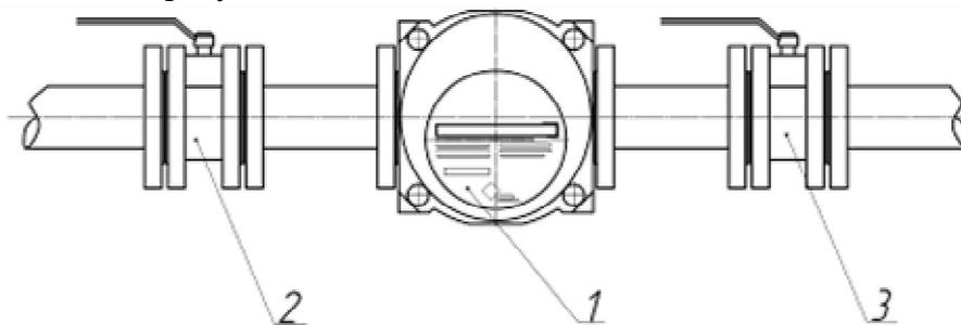
Рисунок 7 - Установка счетчика без перепускного канала
