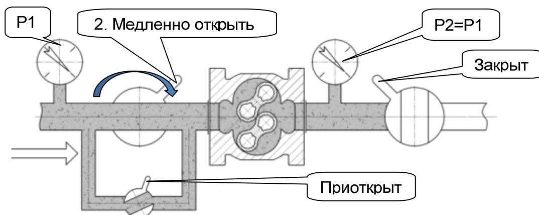
Рисунок 14 – Открытие запорного устройства до счетчика
