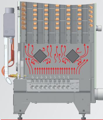
Основной упор в изменениях был сконцентрирован на усиленном турбулировании горячих газов и разрушении ламинарных пленок, т.к. теплопередача на единицу площади в турбулентном потоке может возрастать в разы.
