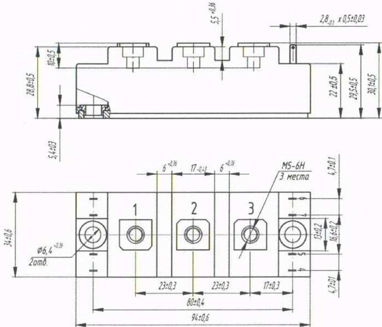
Форма поверхности основания должна быть выпуклой, при этом отклонение от плоскостности на размере  $(80 \pm 0,4)$  мм –  $(30 \div 160)$  мкм, на размере  $(34 \pm 0,6)$  мм –  $(0 \div 50)$  мкм.
