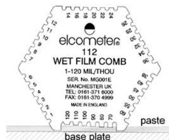
Рисунок 22. Гребёнка для измерения толщины слоя термопасты
