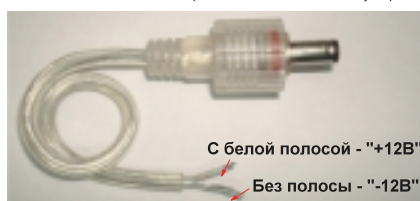
Рис.2. Коннектор питания. Подключается к блоку питания DC 12В
