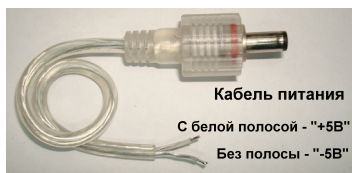
Рис.4. Кабели питания и управления влагозащитенной ленты с индексом «P»
