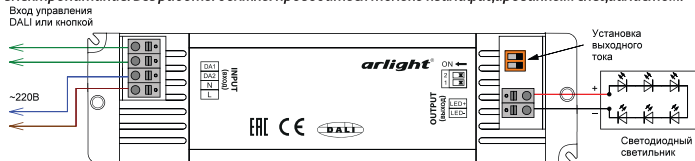
Рис.1. Подключение диммируемого блока питания
