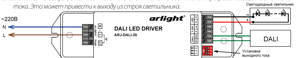
Рис.1. Подключение источника тока при использовании интерфейса DALI.
