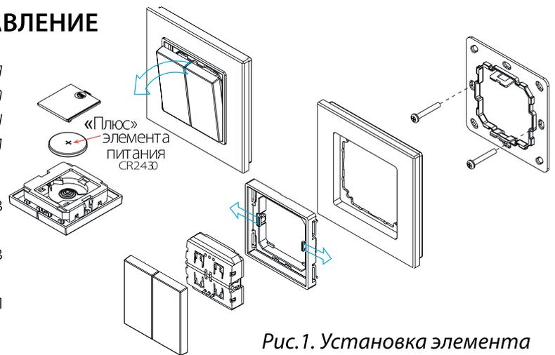
Рис.1. Установка элемента питания и монтаж панели.
