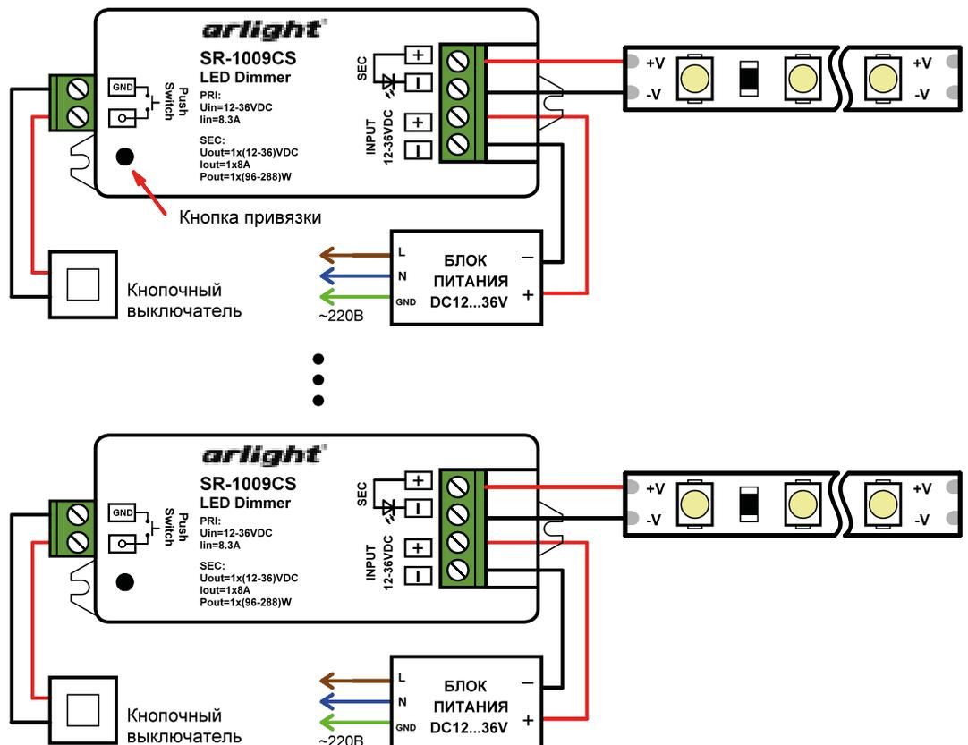
Рис.2. Схема подключения оборудования на примере диммеров SR-1009CS
