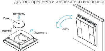
Рис.1. Установка элемента питания
