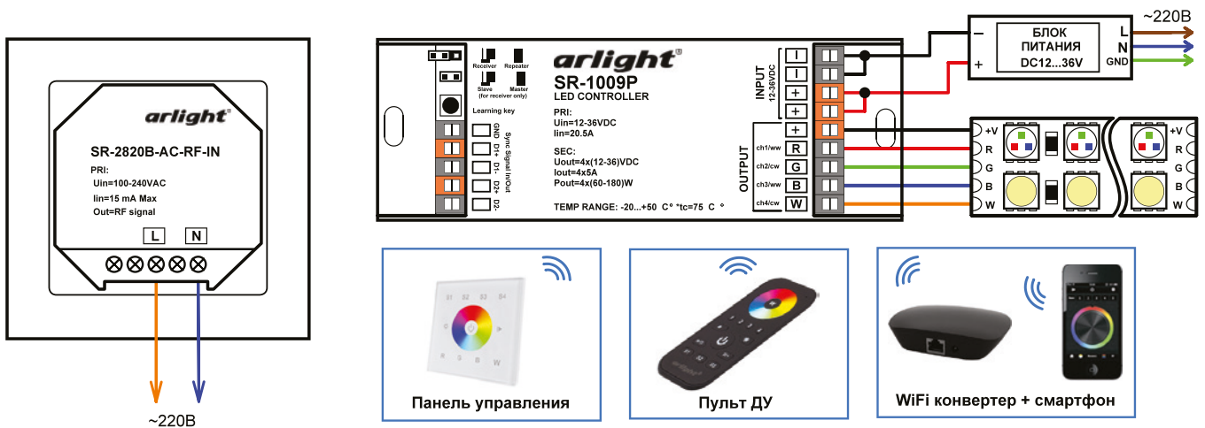
Рис.3. Схема подключения оборудования на примере контроллера SR-1009P
