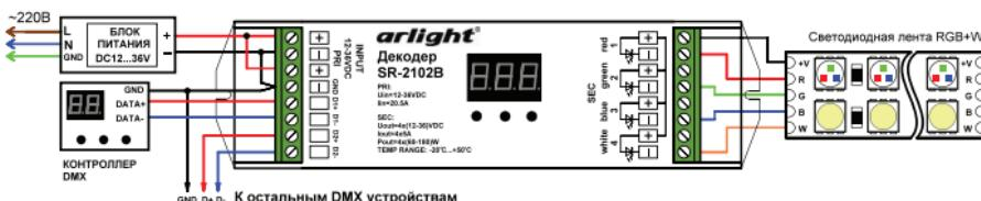
Рис.1. Схема подключения декодера при использовании ленты RGBW и режима 4cH.
