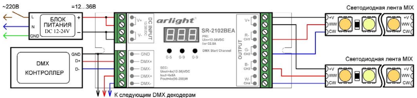
Схема 3. Подключение светодиодной ленты MIX (режим 2ch, WW - теплый белый, CW - холодный белый).
