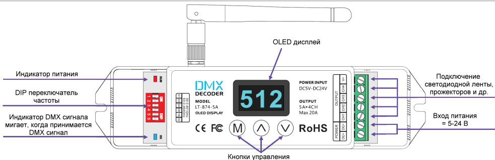
Рис. 1. Органы подключения и элементы управления.
