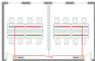
Рис.4. Вариант подключения с возможностью общего или раздельного управления зонами
