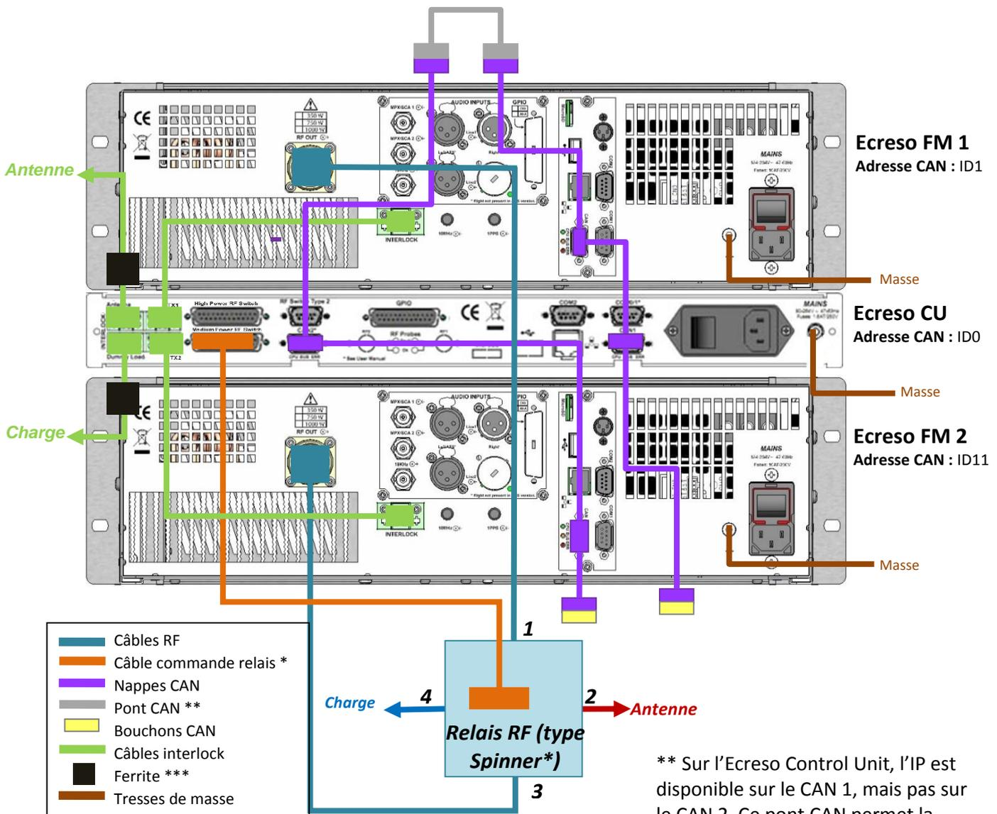
\*\* Sur l'Ecreso Control Unit, l'IP est disponible sur le CAN 1, mais pas sur le CAN 2. Ce pont CAN permet la communication avec le deuxième émetteur.
