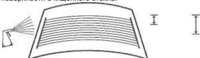
5.4 Отделить плёнку от защитного слоя на 1/3, обильно распылить жидкость на поверхность приклеиваемой плёнки и стекла.
