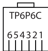
б) обозначение контактов разъема «19» (для исполнений счетчиков с интерфейсами EIA485; EIA232, CE831M0x.03)
