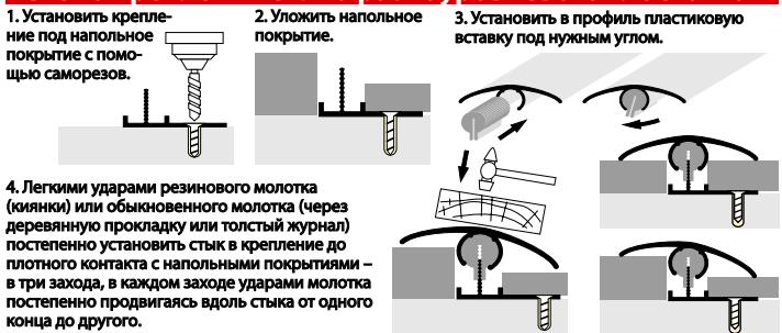
4. Легкими ударами резинового молотка (кинки) или обычного молотка (через деревянную прокладку или толстый журнал) постепенно установить стык в крепление до плотного контакта с напольными покрытиями – в три захода, в каждом заходе ударами молотка постепенно продвигаясь вдоль стыка от одного конца до другого.
