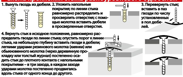
4. Вернуть стык в исходное положение, равномерно распределить покрытия по линии стыка; опустить порог клини и на небольшую глубину вставить гвозди в дюбели; легкими ударами резинового молотка (кинки) или обычного молотка (через деревянную прокладку или толстый журнал) постепенно осадить стык до плотного контакта с напольными покрытиями – в три захода, в каждом заходе ударами молотка постепенно продвигаясь вдоль стыка от одного конца до другого.
