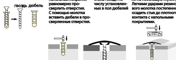
**Схема крепления углов со скрытым креплением**
