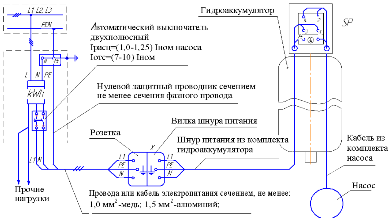
Рисунок 4 – Схема подключения насоса и двухполюсной розетки с заземляющим контактом
