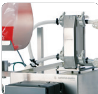
Фильтрующий элемент Sartocon® Slice Self Contained в держателе
