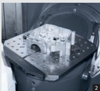
2 – 5: Широкий диапазон наклона наклонно-поворотного стола с управлением от ЧПУ - позволяет решать любые задачи по комплексной обработке
