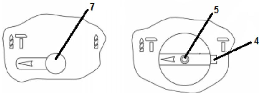
**Внимание!** Переключать переключатели режима работы допускается только при полной остановке всех рабочих элементов прибора.
