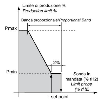
Рис. 14.c Управление с датчиком-ограничителем
