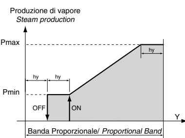
Рис. 14.a Пропорциональное управление
