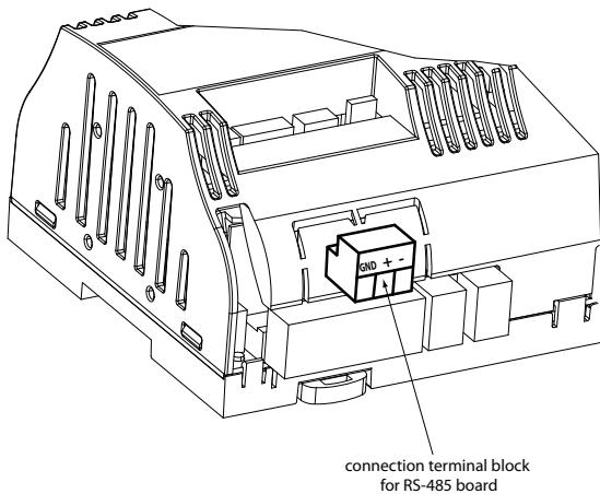
Рис. 5.d (детализация электронной платы, электрическая секция увлажнителя)
