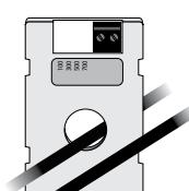
Два витка кабеля одной и той же фазы
